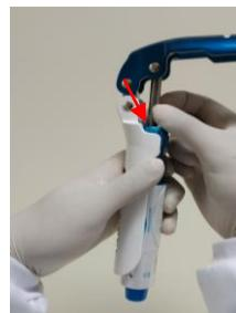
Posicione a haste de aço inoxidável da alavanca dentro do orifício do injetor
